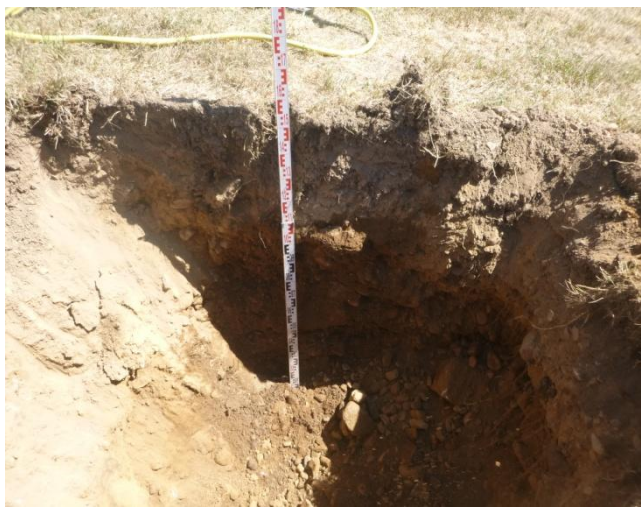
Foto 3: Schurf2; Versickerungssohle 1,5m u. GOK Substrat: Kies, sandig, schwach schluffig, steinig (Foto: Buck, 29.07.2020)
