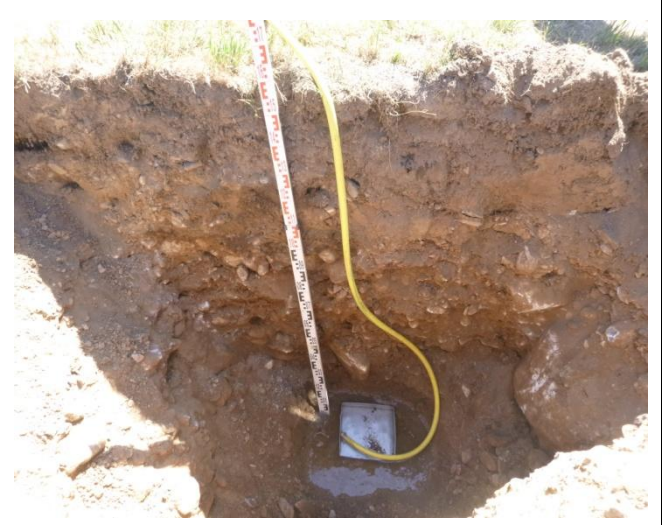
Foto 6: Schurf 5; Versickerungssohle 1,5m u. GOK Substrat: Kies, sandig, steinig, blockführend (Foto: Buck, 30.07.2020)
