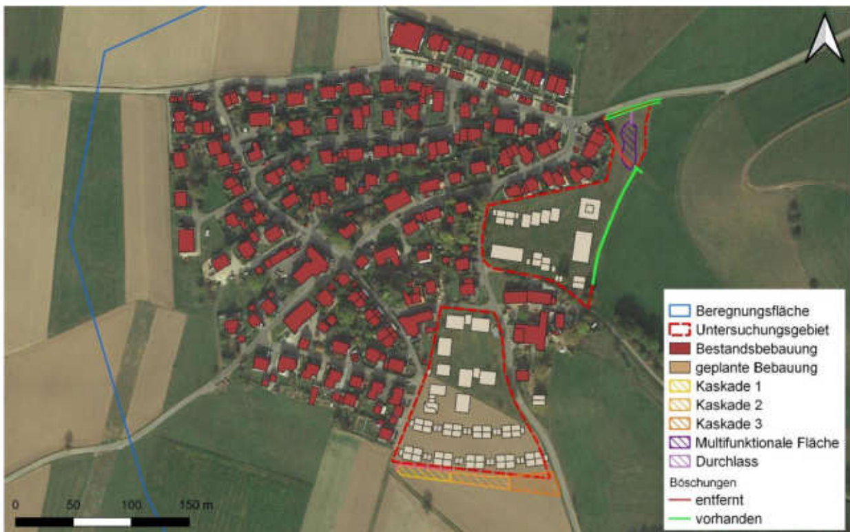
Abbildung 5: Maßnahmen zum Schutz vor Außengebietswasser bei Starkregen
