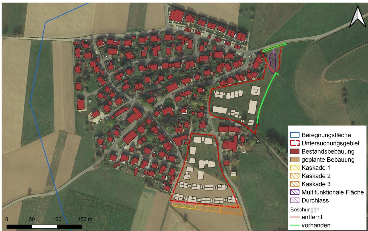
Abbildung 5: Maßnahmen zum Schutz vor Außengebietswasser bei Starkregen
