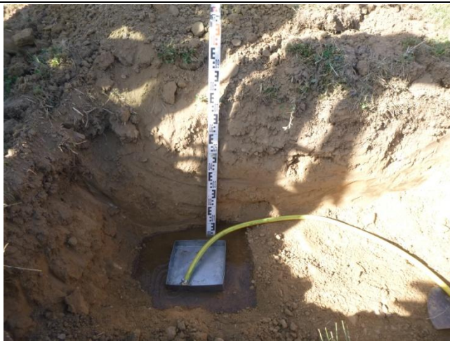
Foto 1: Schurf 1, Versickerungssohle 0,6m u.GOK Substrat: Schluff, sandig bis stark sandig, schwach kiesig (Foto: Buck, 29.07.2020)
