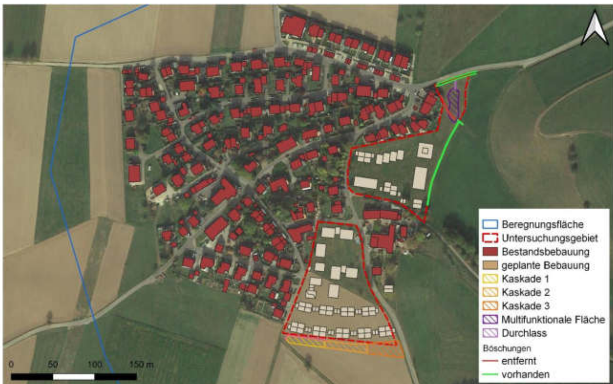
Abbildung 5: Maßnahmen zum Schutz vor Außengebietswasser bei Starkregen
