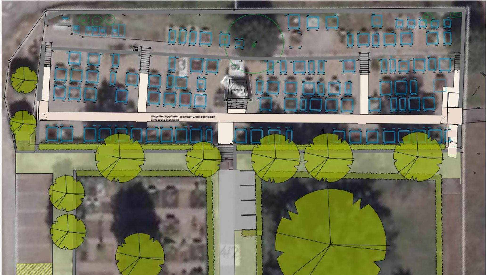
Pflastern des Hauptweges mit Anschluss an die bestehenden Treppen, Versetzen des östlichen Eingangsbereichs, Anlegen einer Rampe zum tieferliegenden Weg um den neuen Friedhof Eschbach
