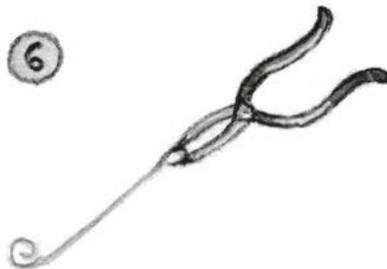
6. Forme den Draht mithilfe der Zange wie auf der Abbildung.
